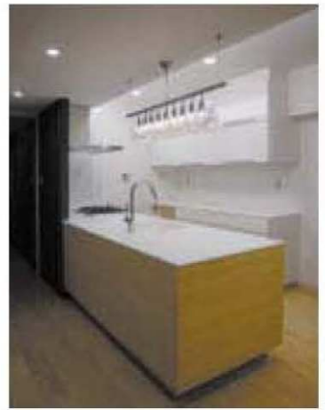
マンションリフォームで作製したアイランド型のオリジナルキッチン。カウンターとシンクは一体型の人工大理石で、扉板には竹材を使用している
